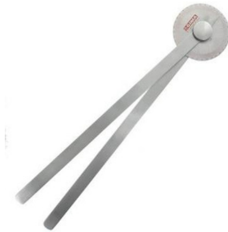
Illustration 27 : Goniomètre à deux branches, livre : Goniométrie, manuel d'évaluation des amplitudes articulaires des membres et du rachis
